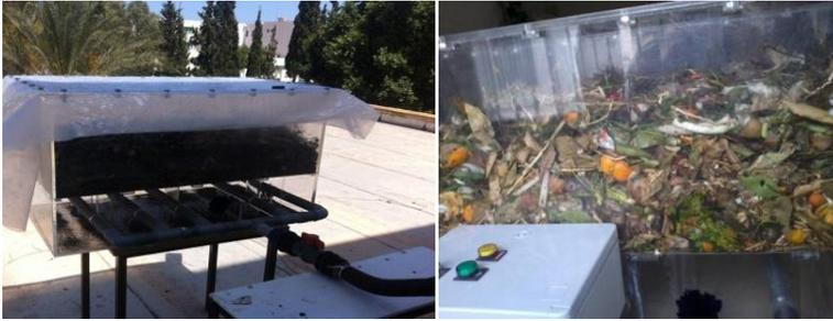
Dans ces travaux préliminaires, l'idée était d'optimiser le procédé de bioséchage en agissant sur le système de ventilation (débit, fréquence de ventilation) et d'étudier son effet sur la température au sein du tas de déchets et par conséquent conclure sur la teneur du produit déshydraté.
